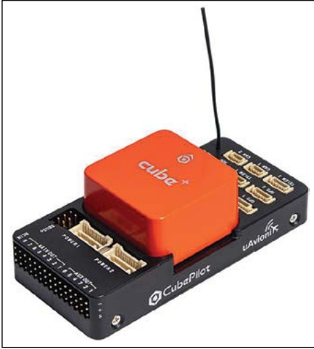
Şekil 58: CubePilot tarafından geliştirilen açık kaynaklı otopilot donanımı Pixhawk Cube
