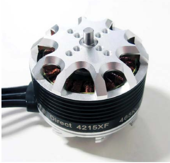
Şekil 53: KDE firmasına ait Bulutaltı İHA'larda kullanılan Elektrik Motoru
